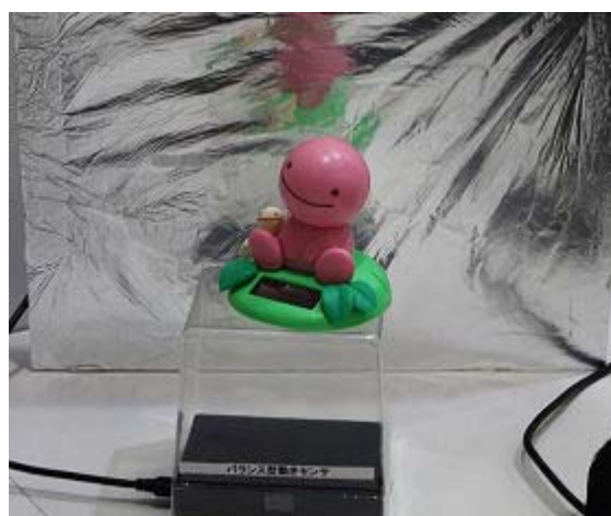
図1 動体のわずかな動きを検出できるとする電磁波を空間に放射し、動体に反射して戻ってきた反射波を継続的に監視する。2系統のアンテナを使って差動処理することで、分解能を高められたという。
